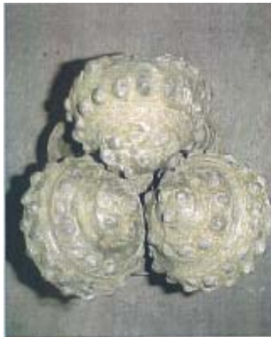
Рис. 7. Износ долота 8 1/2 SN44MRS № 213550. Код износа В2П14ДВ. Проходка на долото 194 м, время бурения 137 ч, мех. скорость 1,4 м/ч
