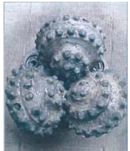
Рис. 6. Износ долота 8 1/2 CH44MRS № 213547. Код износа В1П4Д0. Проходка на долото 154 м, время бурения 104 ч, мех. скорость 1,5 м/ч
