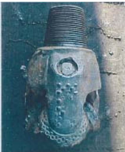
Рис. 4. Лапа долота 8 1/2 CH44MRS № 213545, не контактировавшая со стенкой скважины в процессе бурения
