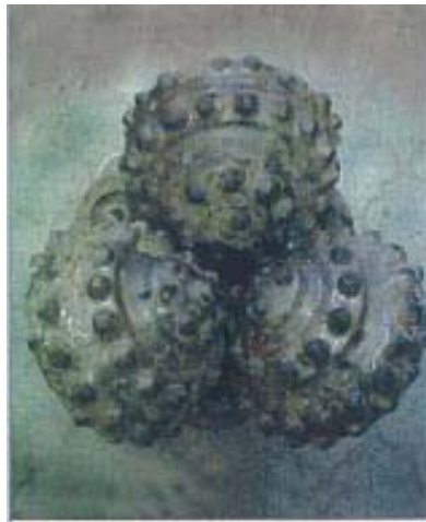
Рис. 8. Износ долота 8 1/2 SN44MRS № 213549. Код износа В1П0Д2. Проходка на долото 241 м, время бурения 174 ч, мех. скорость 1,4 м/ч
