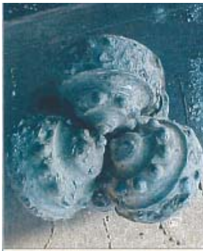
Рис. 5. Износ долота другого производителя. Код износа ВЗПОД5. Проходка на долото 60 м, время бурения 42,5 ч, мех. скорость 1,4 м/ч
