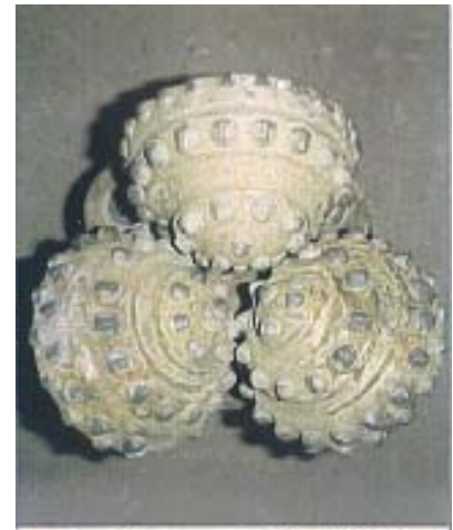
Рис. 9. Износ долота 8 1/2 SN44MRS № 213551. Код износа В1П0Д2. Проходка на долото 147 м, время бурения 114,2 ч, мех. скорость 1,3 м/ч
